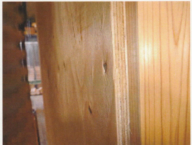
写真4.1.6 釘頭のめり込み(1/50rad時(引き))
