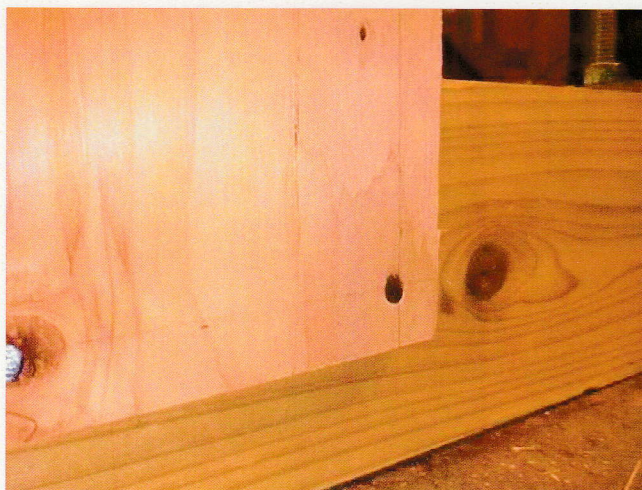
写真4.2.5 釘頭のめり込み(1/75rad時(引き))
