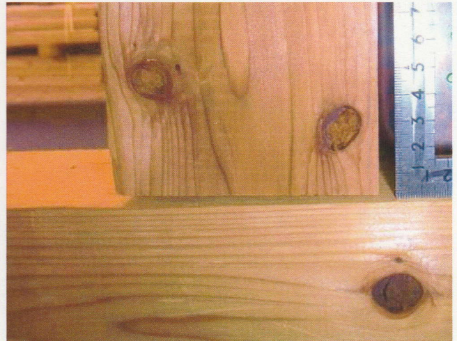
写真4.3.4 右柱脚の浮き(5mm程度)(1/100rad時(引き))
