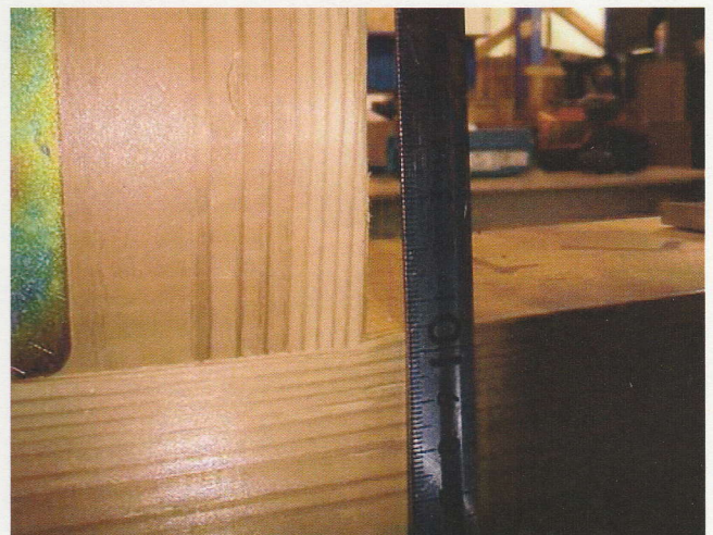
写真4.3.6 左柱脚木口の土台へのめり込み(1/75rad時(引き))
