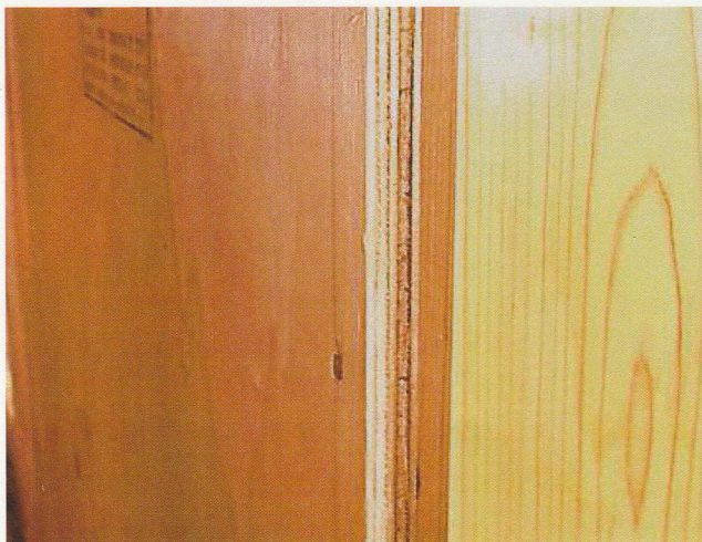
写真4.1.5 釘頭のめり込み(1/75rad時(押し))
