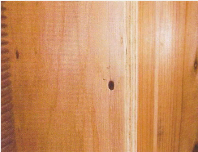
写真4.3.3 釘頭のめり込み(1/100rad時(引き))
